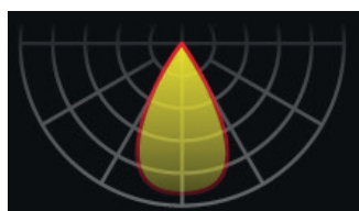
D130x40 Faisceau 130°x40°
